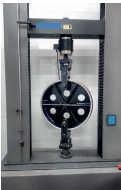
Figura 4 - Ensaio de verificação da resistência à tração circunferencial
