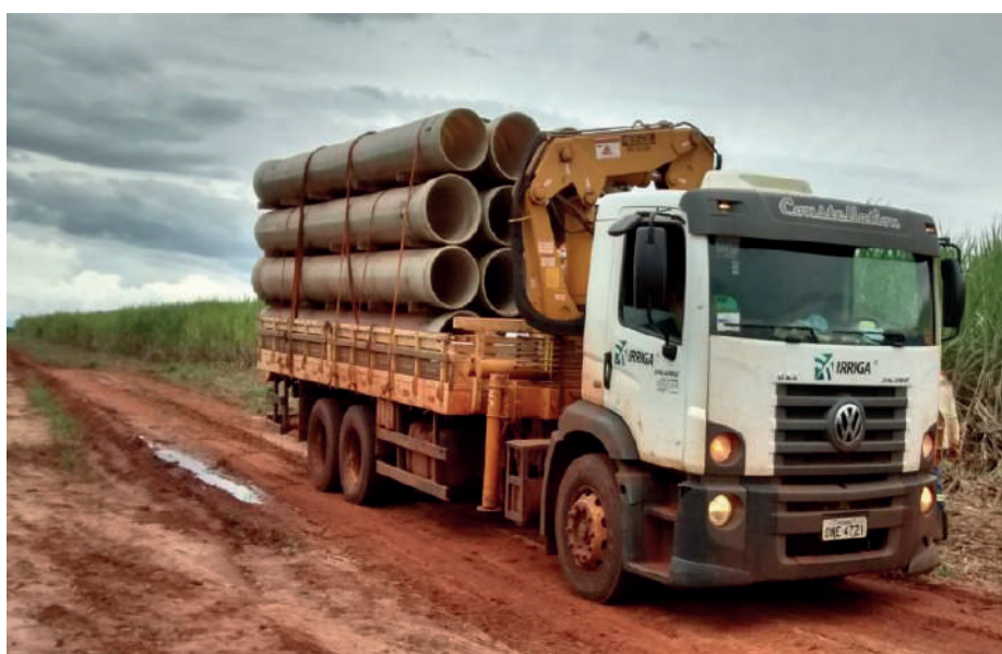
Figura 59 - Transporte de tubos dentro da obra
