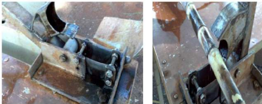
Figura 19 - Guilhotina para corte dos minis rebois em projeto de irrigação da Netafim, Brasilândia de Minas, MG (foto de Daniel Pedroso, 2007).
