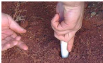
Figura 16 - Instalação dos tensiômetros em projeto de irrigação da Netafim, Passos de Minas (foto de Daniel Pedroso, 2007).
