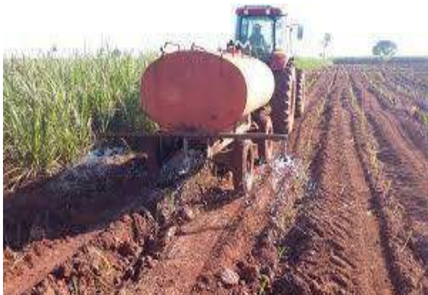
Figura 34 - Caminhão pipa adaptado para irrigação em faixose ou meiosi.
