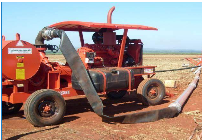
Figura 57 - Estação de Bombeamento Móvel.
