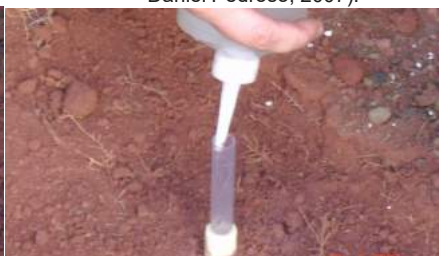
Figura 17 - Completar o tensiômetro com água em seu interior. Projeto de irrigação da Netafim, Passos de Minas (foto de Daniel Pedroso, 2007).
