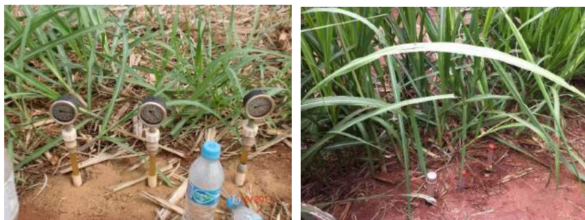
Figura 18 - Tensiômetros analógicos (à esquerda) e digital (à direita) em projetos de irrigação. (foto de Daniel Pedroso, Netafim, Bariri – SP, 2011 e 2020).
